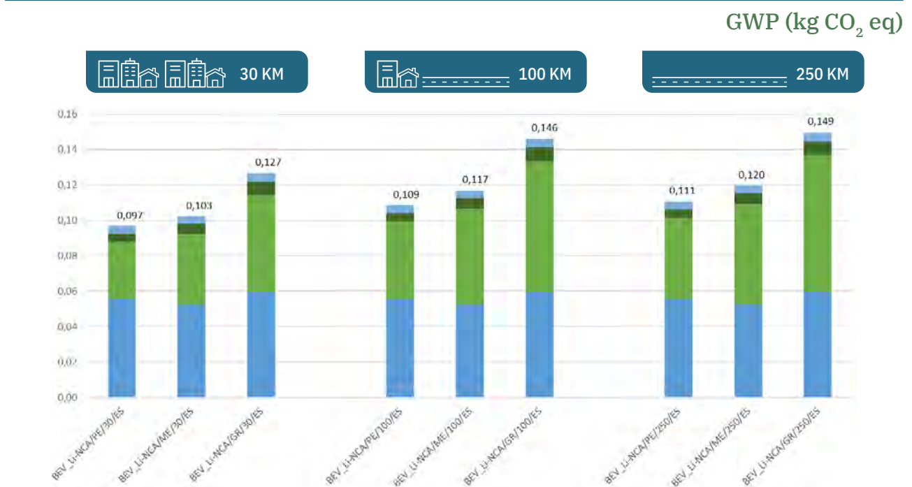
Gráfica 139 – Impacto en cambio climático de un vehículo eléctrico BEV con batería de ion Litio NCA que circula por España (ES), agrupando recorridos y variando el tamaño (kg CO 2 eq.)
