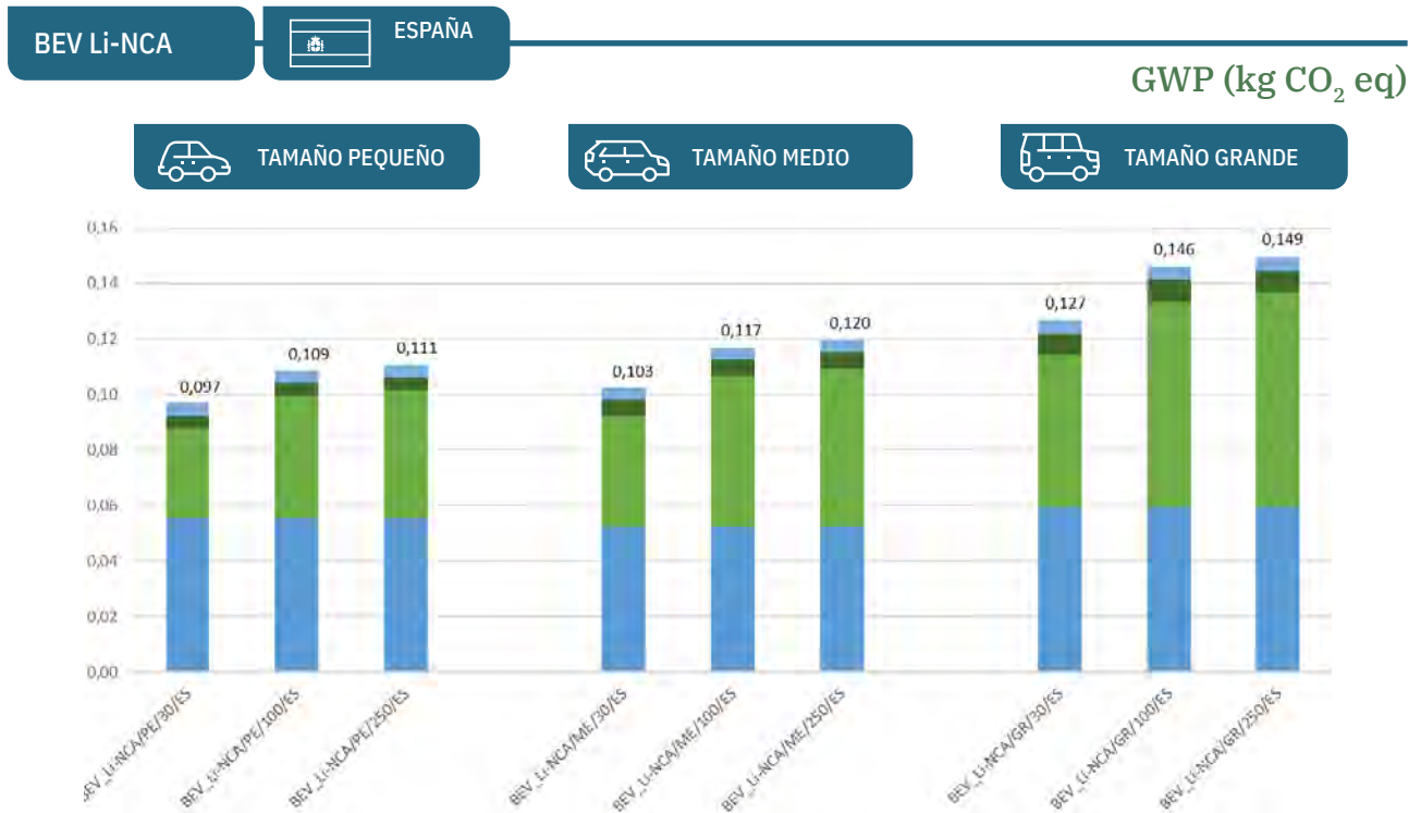
Gráfica 138 – Impacto en cambio climático de un vehículo eléctrico BEV con batería de ion Litio NCA que circula por España (ES), agrupando tamaños y variando el recorrido (kg CO 2 eq.)
