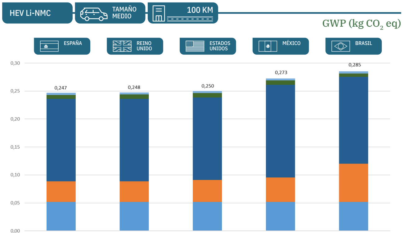
Gráfica 154 – Impacto en cambio climático de la influencia de cada país, para un vehículo híbrido HEV, con batería de ion Litio NMC, de tamaño mediano (ME), que realiza un recorrido mixto de 100 km (kg CO 2 eq.)
