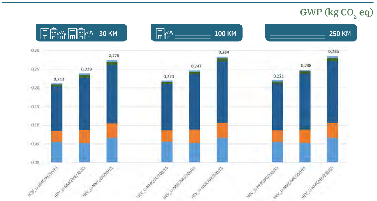
Gráfica 127 – Impacto en cambio climático de un vehículo híbrido HEV con batería de ion Litio NMC que circula por España (ES), agrupando recorridos y variando el tamaño (kg CO 2 eq.)
